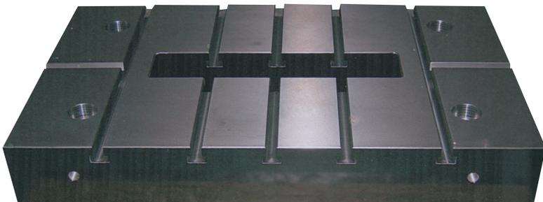
**注意:** 噛み込みによる欠損を防ぐため切りくずが溝に残らないように前から溝側にエアで強く吹き飛ばして下さい
